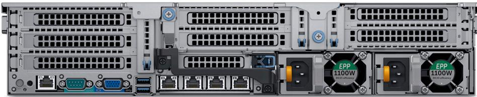
Visão posterior do R740 — com 4 slots PCIe disponíveis com placas de proteção nas risers 2 e 3
