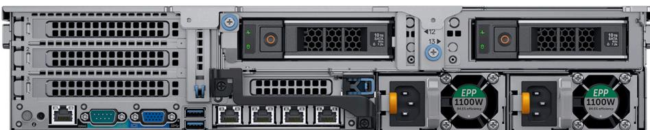
Visão posterior do R740xd — com backplane de 4 unidades de 2,5 polegadas instalado
